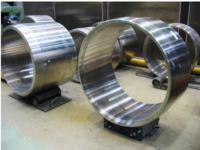
Rys. 31. Kołpaki wirników generatorów (paramagnetyki)
