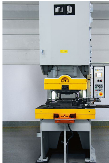
Rys. 5. Prasa po modernizacji - mechaniczny układ krzywkowy prasy mimośrodowej zastąpiono w pełni elektronicznym rozwiązaniem firmy Pilz
