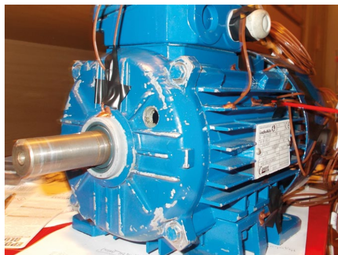
Rys. 15. Miejsca zainstalowania termopar na zewnątrz maszyny
