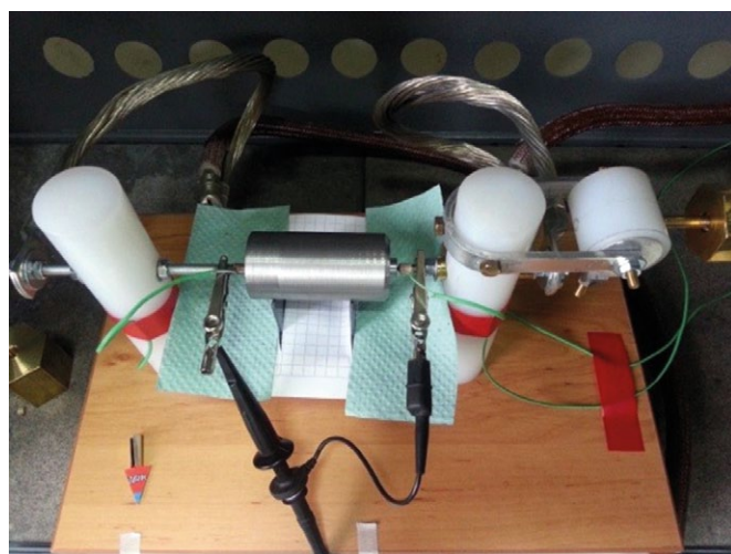
Rys. 5. Układ do wyznaczenia rezystancji styków metodą techniczną
