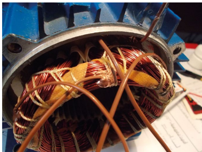
Rys. 14. Miejsca zainstalowania termopar wewnątrz maszyny
