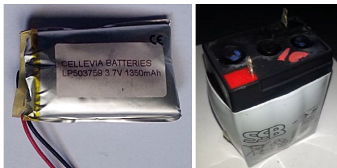
Rys. 2. Przykład ogniw z zaciskami do lutowania (widoczne odkształcenia obudowy po badaniach)
