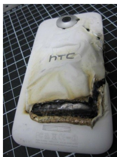
Spalony telefon typu smartfon (źródło: www)
