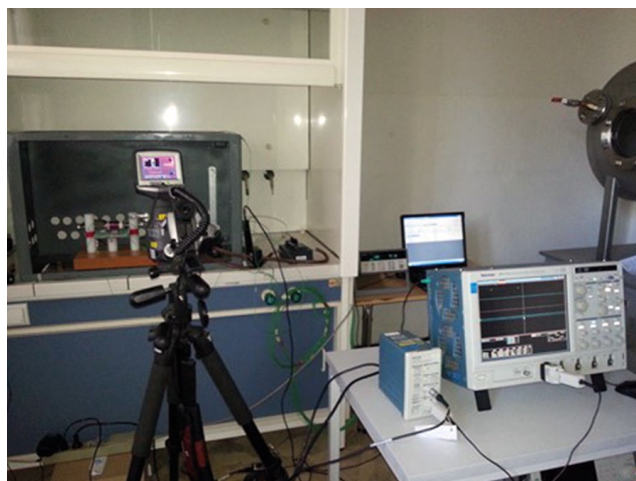
Rys. 10. Stawisko do badań zwarcioch akumulatorów
