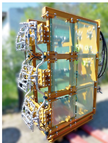
Stanowisko do stacjonarnego badania elementów i układów napędu jazdy
