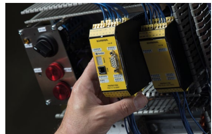
Str. 48 PROTECT PSC1 - Najnowsza generacja sterowników bezpieczeństwa. Programowalne, modułowe, wielofunkcyjne i ekonomiczne
