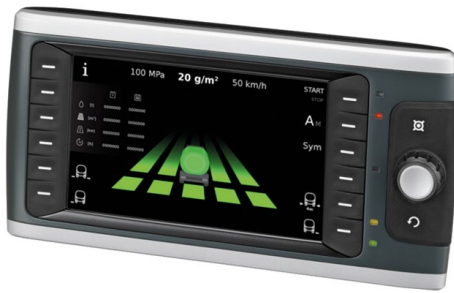
Rys. 3. Interfejs graficzny na panelu BODAS DI4 firmy Bosch Rexroth w VAMMAS CSBH 3600
