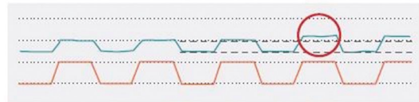
Zwiększenie zużycia tylko wtedy, gdy zawór jest załączony → anomalia/wyciek w dopływie lub przed zaworem
