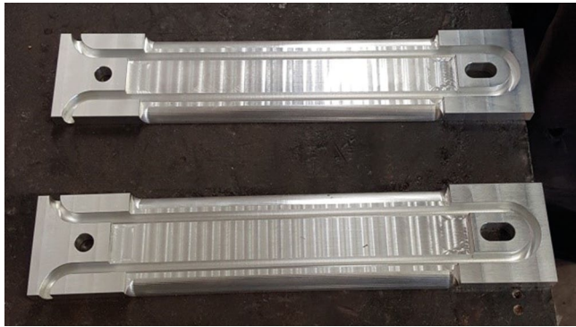
Rys. 5. Chłodnice panelowe dławika filtru LC z pośrednim chłodzeniem wodnym
