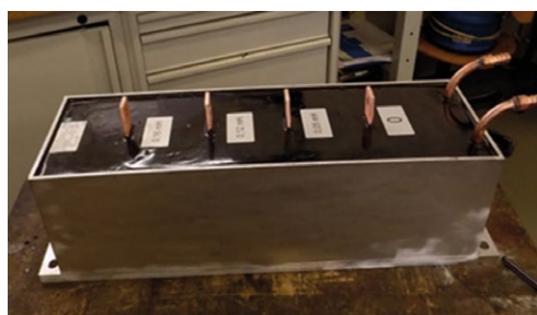
Rys. 9. Jednofazowy dławik z odczepami typu 1RTFW-0,05-0,12-0,16 mH / 300 A 25 kHz z pośrednim chłodzeniem wodnym
