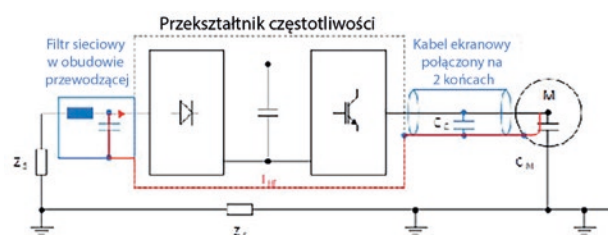
Rys. 2. Ten sam schemat z zaznaczonymi kolorem niebieskim dwoma nowymi elementami: przewodem ekranowanym, który łączy falownik z silnikiem i filtrem sieciowym
