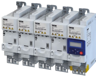
Montaż książkowy przemiennika i500 (0 mm odstepu) bez spadku mocy
