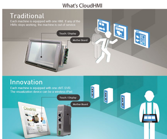
Rys. 8. Idea działania CloudHMI i urządzenia cMT-SVR – bezprzewodowa kontrola nad maszyną
