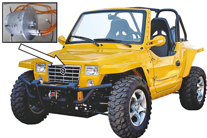
Rys. 8. Pojazd sportowo-rekreacyjny [24] napędzany silnikiem z magnesami trwałymi
