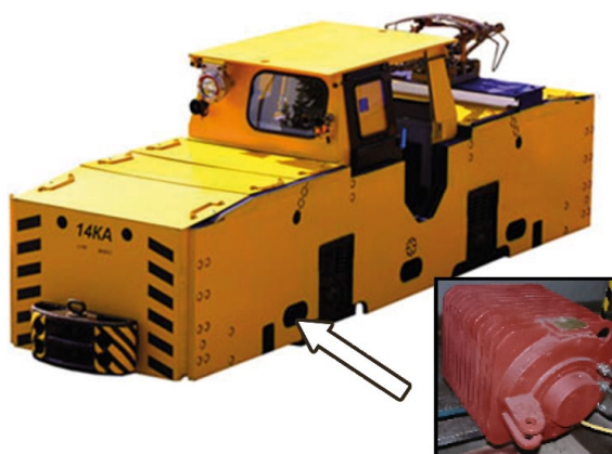
Rys. 13. Silnik z magnesami trwałymi w zastosowaniu w bardzo trudnych warunkach eksploatacji
