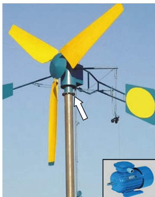
Rys. 15. Doświadczalna elektrownia wiatrowa z prądnicą z magnesami trwałymi o mocy 6 kW
