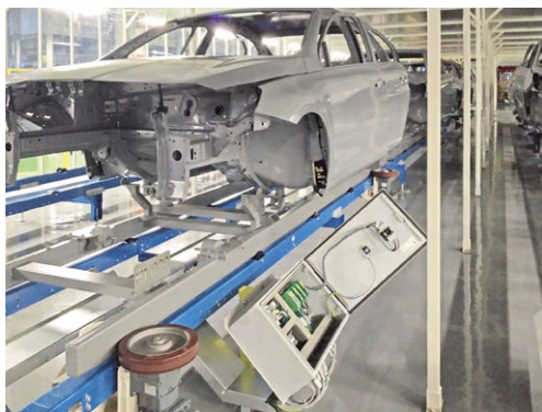
Fot. 4. System transportowy karoserii samochodowych sterowany sieciowymi rozrusznikami silnikowymi
