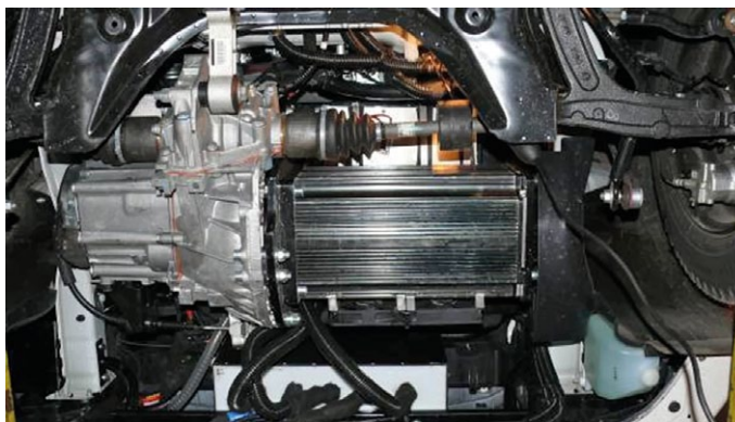
Rys. 3. Napęd pojazdu Fiat Panda 2 z falownikiem IGBT
