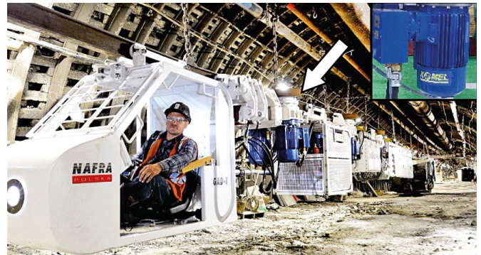
Rys. 12. Kolejka GAD-1 z silnikiem z magnesami trwałymi
