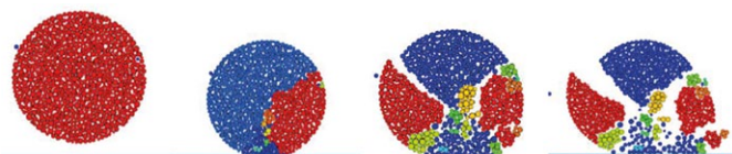
Rys. 6. Symulacja rozkruszenia granulki na skutek upadku z wysokości na sztywne podłoże
