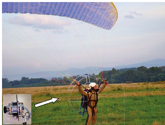
Rys. 9. Prototypowa paralotnia plecakowa z napędem elektrycznym
