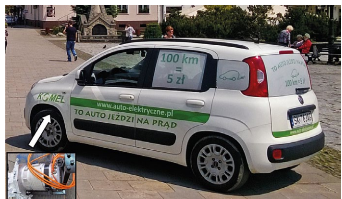
Rys. 6. Samochód elektryczny Fiat Panda z silnikiem elektrycznym o mocy 41 kW
