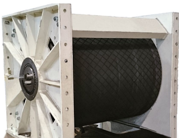
Rys. 14. Prototypowy silnik z wirnikiem zewnętrznym o mocy 250 kW [22]
