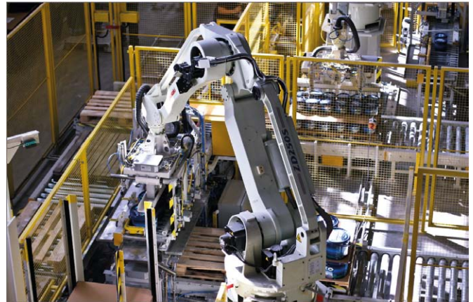
Rys. 2. Stanowisko z robotem Kawasaki ZD250 do paletyzacji wiader z farbą w Fabryce Farb i Lakierów Śnieżka SA w Lubzinie (Źródło: ASTOR)
