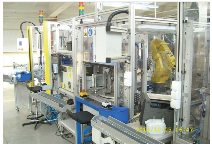
Rys. 3. Montaż instrumentu pomiarowego gazomierza w Aparator Metrix SA (Źródło: FANUC)
