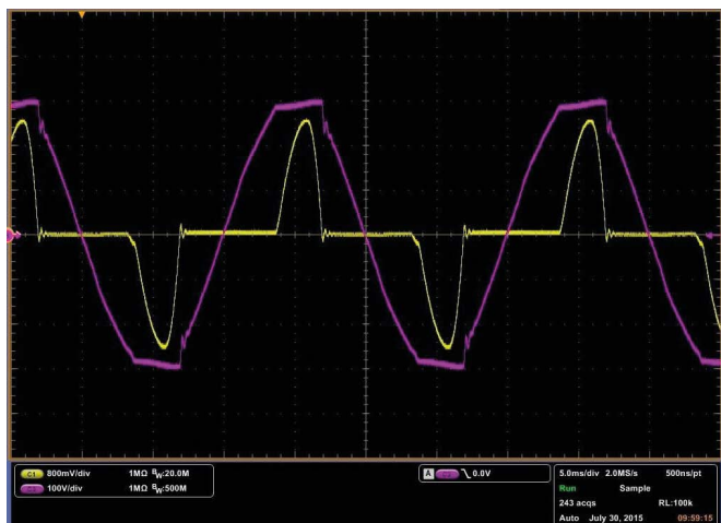
Rys. 3. Napięcie i prąd na zasilaniu bez PFC
