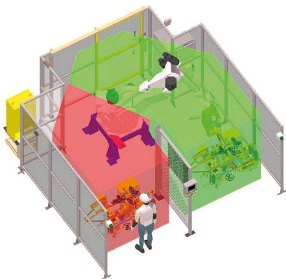
Rys. 5. Monitorowanie obszaru pracy systemem Cubic-S firmy Kawasaki (praca robota dozwolona w strefie zielonej, zabroniona w strefie czerwonej) (Źródło: ASTOR)
