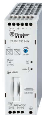
Typ 78.1D • Wyjście 24 V DC, 130 W • Dwustopniowy z aktywnym PFC (Power Factor Corrector)
