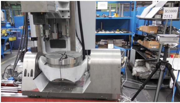
Rys. 10. Centrum obróbkowe Andrychowskiej Fabryki Maszyn DEFUM SA R1000 „Baca” oraz interferometr laserowy podczas pomiaru wpływu odkształceń cieplnych na dokładność pozycjonowania osi X
