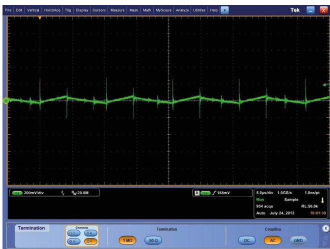
Rys. 5. Tętnienia przy obciążeniu znamionowym 78.1D
