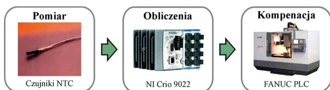
Rys. 8. Schemat przekazywania sygnałów w układzie kompensacji
