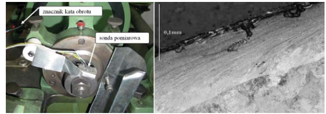
Rys. 4. Stanowisko badawcze i efekty degradacji stanu powierzchni [12]
