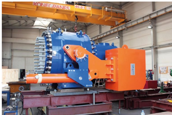
Rys. 1. Zawór kulowy BLV-3P-M produkcji TB Hydro Sp. z o.o.
