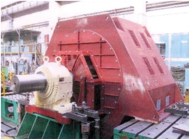
Rys. 1. Widok silnika asynchronicznego synchronizowanego, typ: SASf-1612LX
