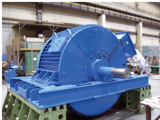
Rys. 8. Widok silnika LSPMSM, SMH-1732M
