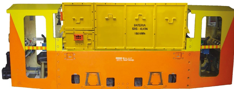
Bateria SBS-4Lion 150 kWh zabudowa na lokomotywie typu ELA-44
