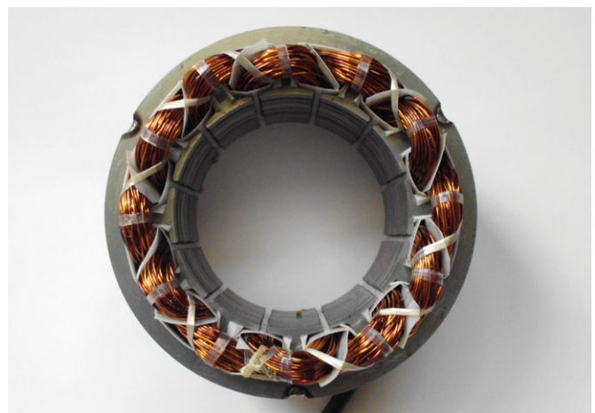
Rys. 3. Stojan generatora z cewkami skupionymi
