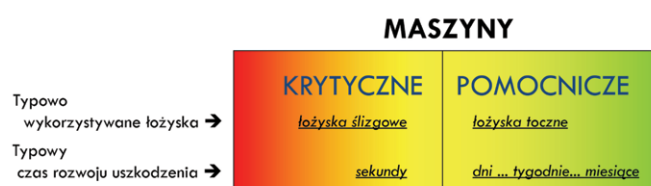
Rys. 1. Zróżnicowanie konstrukcyjne majątku produkcyjnego i jego wpływ na tempo zmiany stanu technicznego
