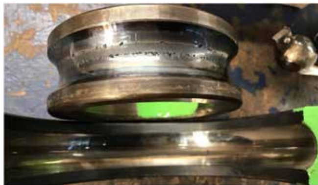
Rys. 12. Pierścienie łożyska tocznego uszkodzone elektroerozją
