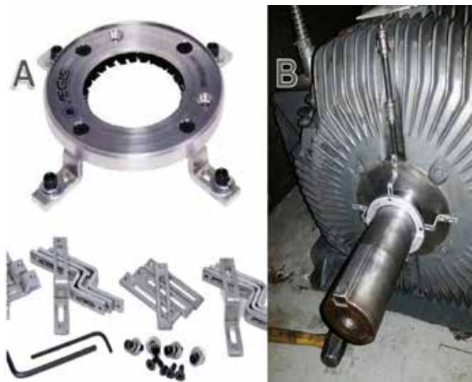
Rys. 23. Pierścień uziemiający przed (A) i po zainstalowaniu na silniku (B)
