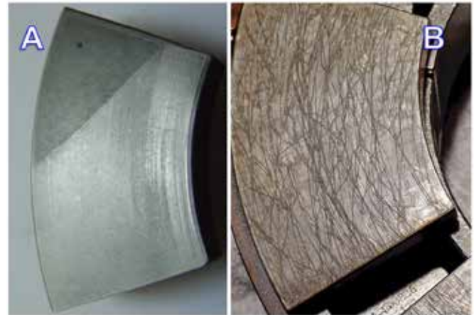
Rys. 16. Segmenty łożyska oporowego uszkodzone elektroerozją: (A) zaszronienie; (B) zarysowania
