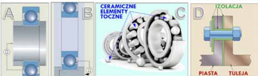
Rys. 21. Minimalizacja prądów pasożytniczych przez zastosowanie izolacji
