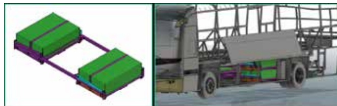
Rys. 4 i Rys. 5. - Zabudowa zasobników energii w strukturze autobusu (3, 4)
