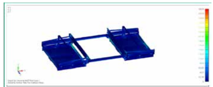
Rys. 2 – Naprężenia globalne w wariantcie wysuniętych do połowy szuflad magazynów energii (2)
