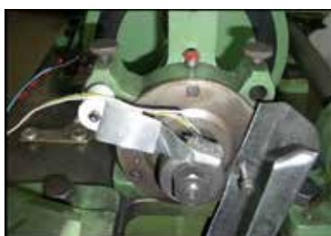
Rys. 19. Podczas pomiaru składowej natężenia pola magnetycznego H_t
