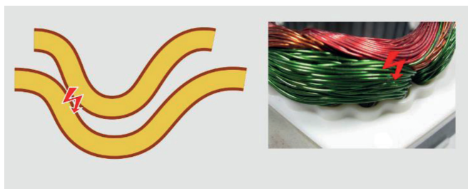
Rys. 3. Wyładowanie niezupełne w małej szczelinie powietrznej
