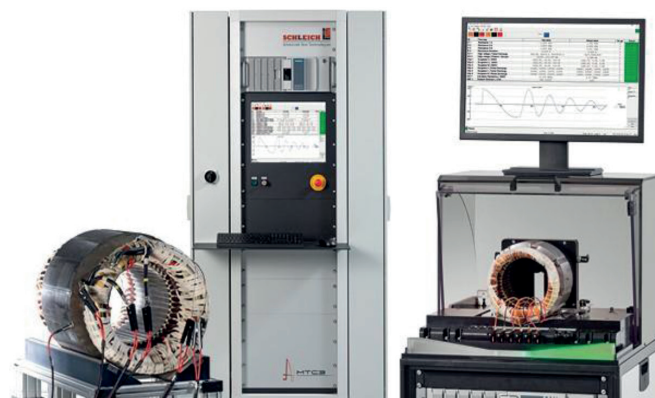
Rys. 22. Systemy MTC3 stosowane na produkcji w liniach montażu, w kontroli jakości lub w działach R&D
