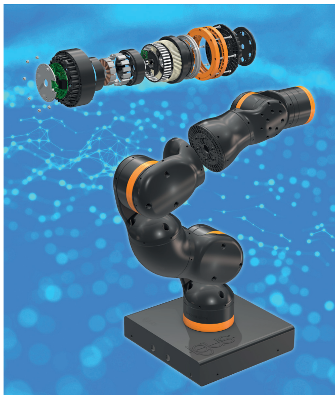
Robot Rebel to pierwszy robot wykonany z wysokowydajnego tworzywa sztucznego. Przy masie zaledwie 8 kg, jest najlżejszy w swojej klasie: prawdziwie lekki robot. (Źródło: igus GmbH)
