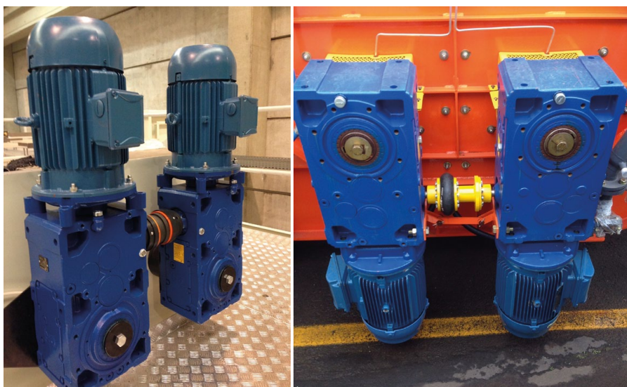
Mieszalniki synchroniczne zrealizowane z wykorzystaniem napędów stożkowo-walcowych Rossi
