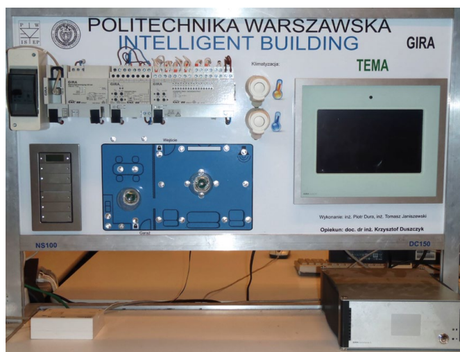
Rys. 5. Stanowisko systemu KNX z Gira HomeServer 3
