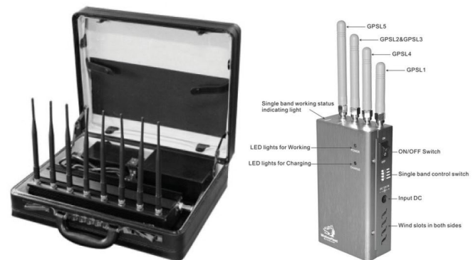
Rys. 11. Urządzenia do zagłuszania sygnałów GNSS są obecnie precyzyjnie dopasowane częstotliwością i pasmem do typu wiązki, a nawet sposobu jej kodowania
