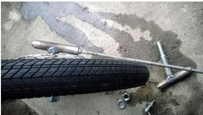
Rys. 6. Prototyp zwrotnicy, widoczny dodatni promień zataczania
