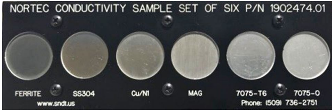
Rys. 13. Zestaw sześciu wzorców dla testów konduktywności
