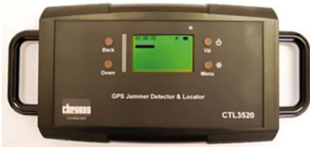
Rys. 16. Urządzenie rozpoznające zagłuszanie i wskazujące kierunek źródła
