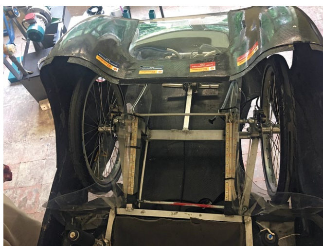
Rys. 9. Układ kierowniczy bolidu SAW na rok 2017
