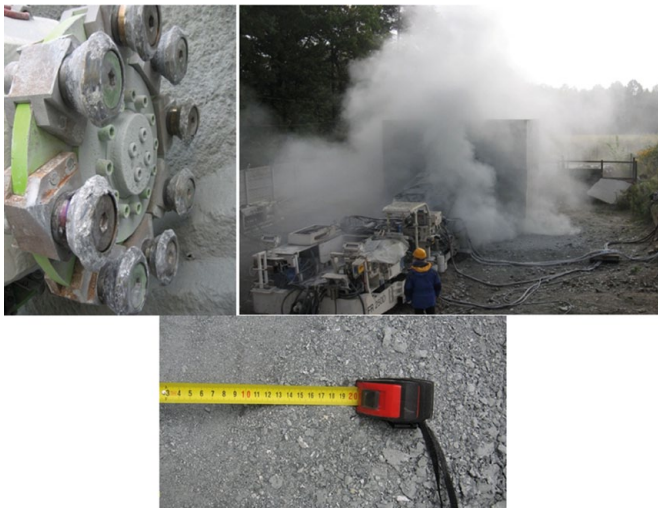
Rys. 25. Widok narzędzi dyskowych, uziarnienia urobku oraz generowanego zapylenia podczas zwiększonych wartości liczby obrotów tarcz z narzędziami dyskowymi
