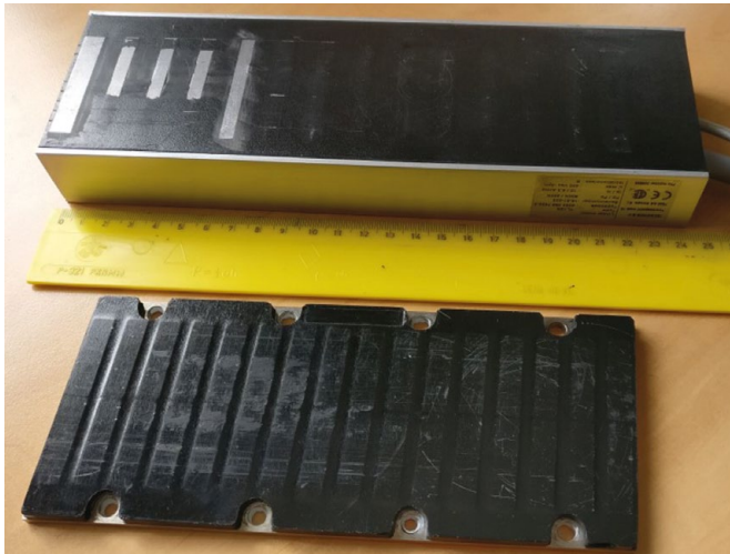
Rys. 1. Przykład silnika CW-FLPMSM, u góry widoczny biegnik z częściowo odsloniętymi zębami rdzenia, na dole bieźnia magnetyczna z magnesami trwałymi
