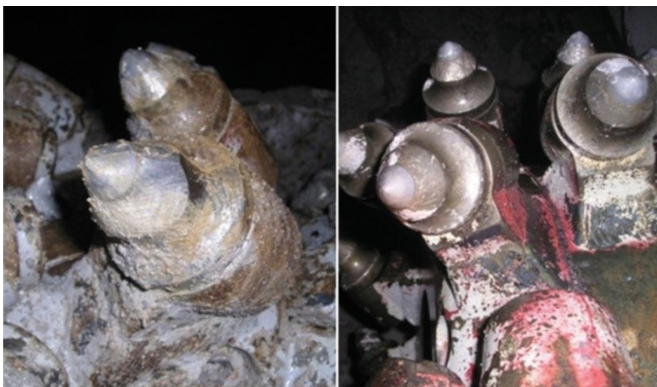
Rys. 18. Widok zużycia noży po urobieniu 2 mb chodnika: po lewej – zamocowanych w uchwytach standardowych; po prawej – w uchwytach zasilanych wodą [11]
