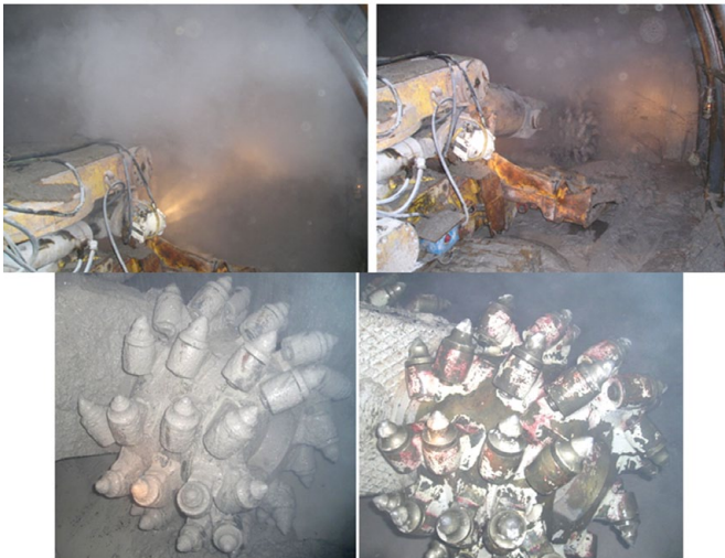
Rys. 17. Widok kombajnu R 130 podczas urabiania chodnikowego przodka kamiennego i organu urabiającego po próbach dołowych urabiania: z organem z uchwytami standardowymi (po lewej); z organem wyposażonym w uchwyty zasilane wodą (po prawej) [11]
