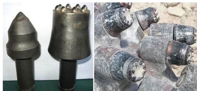
Rys. 19. Widok standardowego noża stycznno-obrotowego oraz specjalnego noża koronowego [7, 9]
