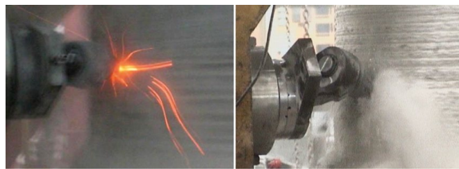
Rys. 4. Widok iskrzenia tarcowego oraz generowanego zapylenia podczas skrawania próbki skalnej nożem styczo-obrotowym [9]
