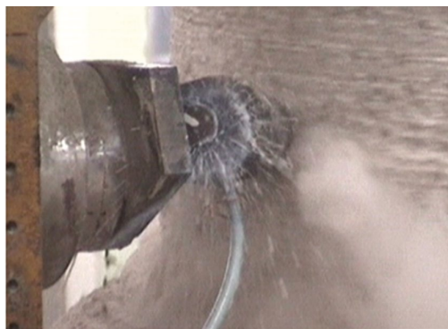
Rys. 14. Zmodernizowany, wspomagany cieczą pod ciśnieniem uchwyt noży stycząco-obrotowych: 1 – uchwyt nożowy; 2 – króciec doprowadzający; 3 – tuleja [11]
