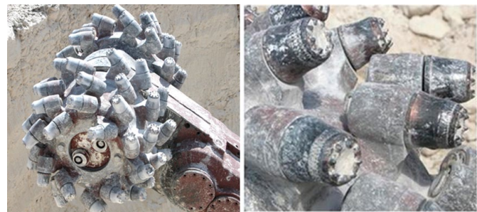
Rys. 21. Widok organu i noży koronowych po dwóch zmianach roboczych [7, 9]
