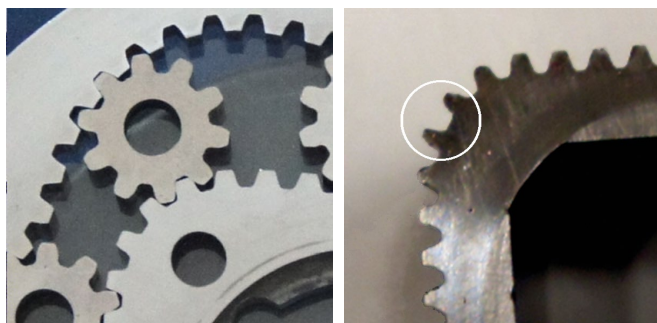
Rys 8. Zazębienie satelity z garbem planety – mechanizm nowy (a); zużycie zębów planety w obrębie garbu (b) [7]
