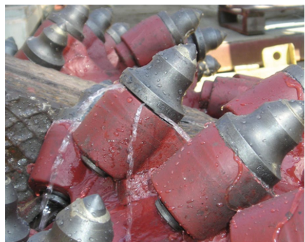
Rys. 16. Widok wypływu medium smarowego z uchwytu [11]
