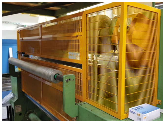
Rys. 3. Zabezpieczenie dostarczone i zainstalowane po interwencji organu nadzoru rynku
