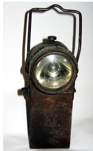
Akumulatorowa lampa typu U-6 dla dozoru
