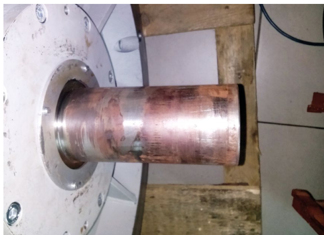
Rys. 1. Uszkodzenia powierzchni czopa wału spowodowane przepływem prądu wałowego
