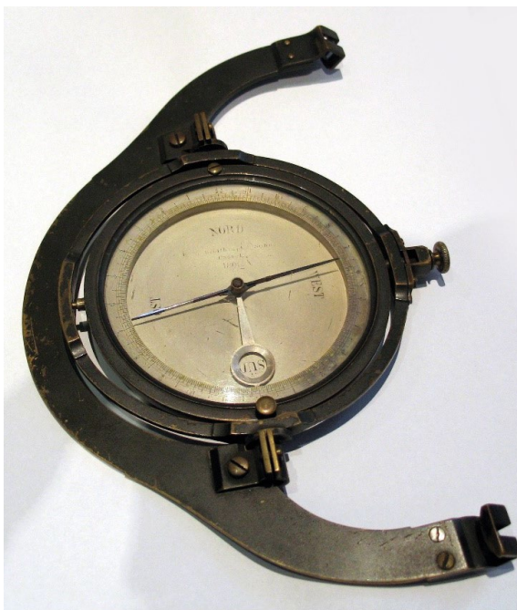
Kompas górniczy firmy F. Breithaupt Cassel
