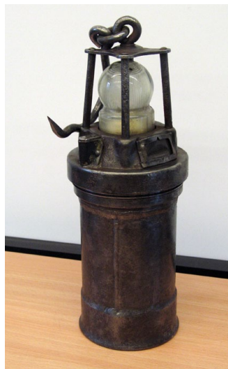
Osobista lampa górnicza typu R-28
