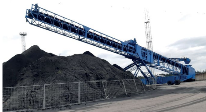
Rys. 1. Ciężki przenośnik samobieżny – w trakcie przejazdu oraz gotowy do pracy
