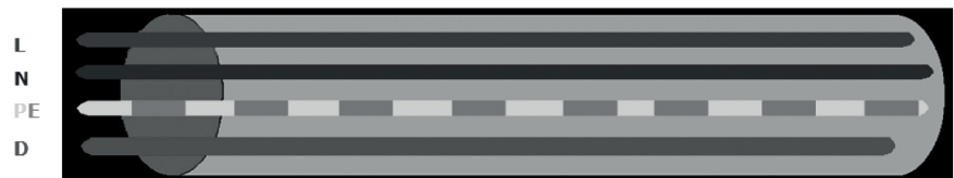
Rys. 3.1. Podstawowy przekrój przewodu używany w systemie LCN
