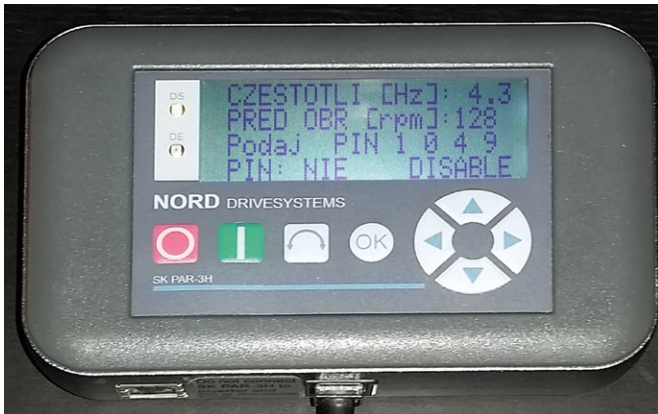
Fot. 2. Realizacja blokady serwisowej, np. po ustalonym czasie pracy
