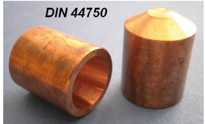
Rys. 6. Elektrody z miedzi stopowej CuCrZr przerabianej plastycznie metodą wyciskania hydrostatycznego [12]
