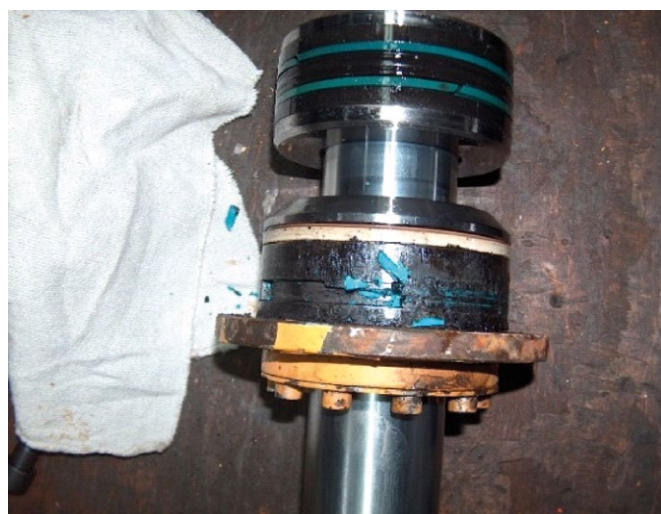
Rys. 1. Schemat siłownika dwustronnego działania wraz z przykładem degradacji uszczelnień siłownika w efekcie oddziaływania wysokiej temperatury oraz zanieczyszczeń
