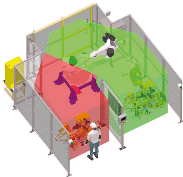
Rys. 14. Symulacja systemu bezpieczeństwa Cubic-S firmy Kawasaki
