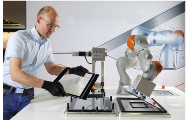
Rys. 16. Robot firmy KUKA precyzyjnie układający szklane panele
