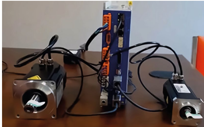
Sprzężenie krzyżowe z 2-osowym napędem Copley
