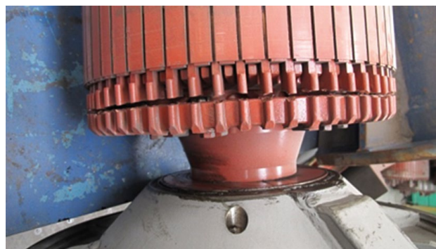
Rys. 2. Wirnik silnika zespołu trakcyjnego EN 57 z urwanym pierścieniem
