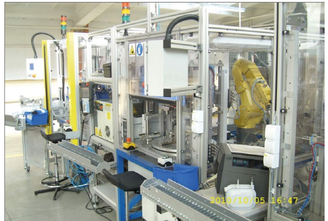
Rys. 9. Montaż instrumentu pomiarowego gazomierza w Aparator Metrix SA (Źródło: FANUC)
