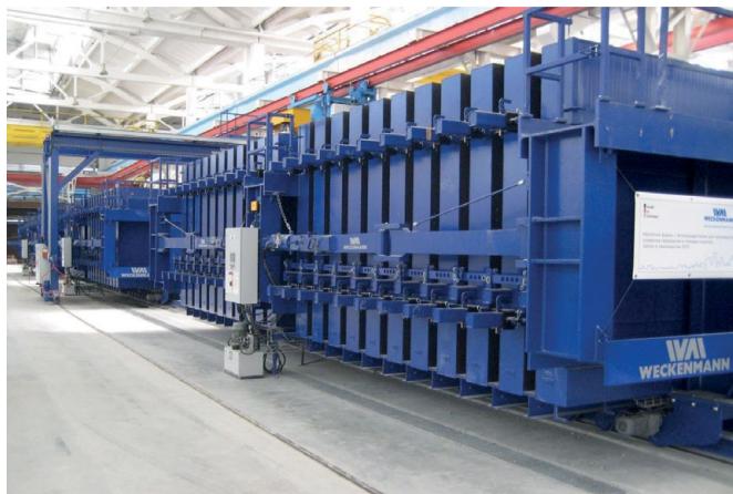
Fot. 12. Formy bateryjne firmy Weckmann do produkcji elementów płytowych i ściennych [17]
