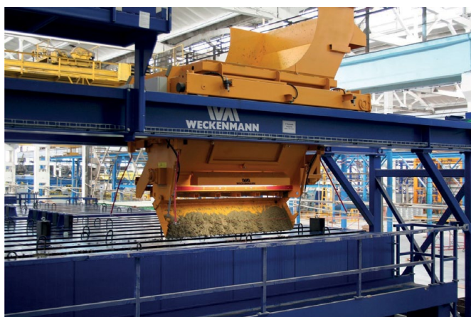
Fot. 13. Proces napełniania form bateryjnych mieszanką betonową [17]
