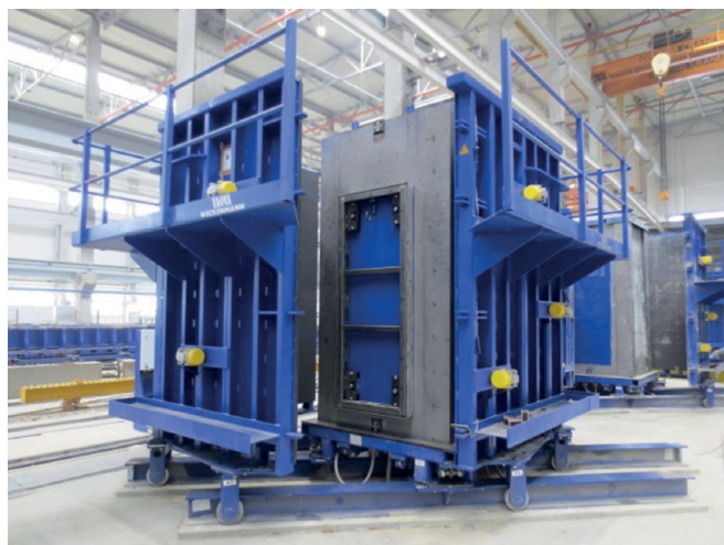
Fot. 15. Stalowa przestrzenna forma firmy Weckmann [17]
