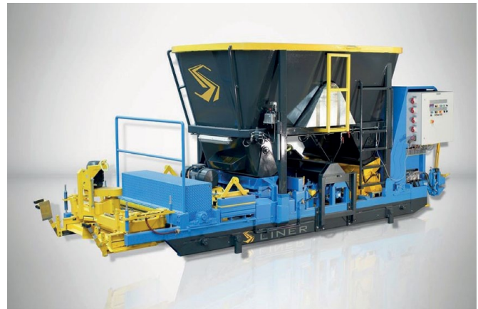
Fot. 8. Agregat przesuwany S-Liner® do formowania ślizgowego betonu, wykorzystywany do produkcji prefabrykowanych elementów strunobetonowych [10]
