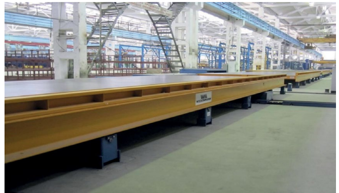
Fot. 16. Stalowe blaty (palety) firmy Weckenmann do formowania odmiennego asortymentu prefabrykatów dla budownictwa [17]
