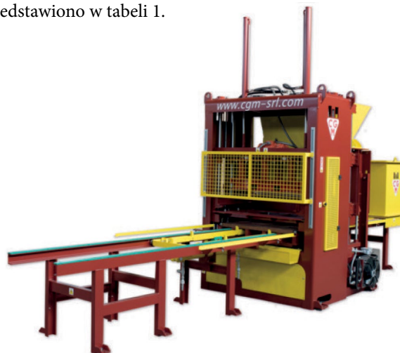
Fot. 4. Stacjonarny agregat do produkcji bloków firmy CGM typu 60H [15]
