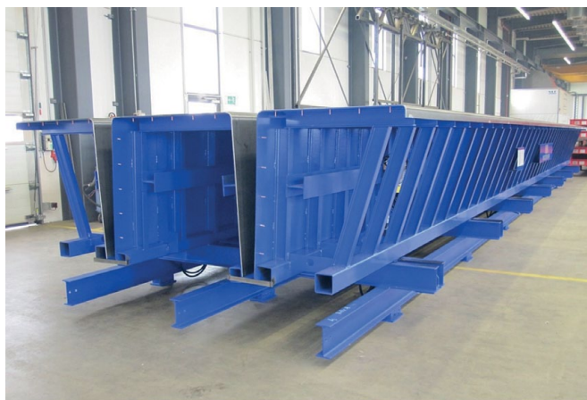
Fot. 9. Stalowa nierozbieralna forma firmy Weckenmann do produkcji płyt typu TT [17]
