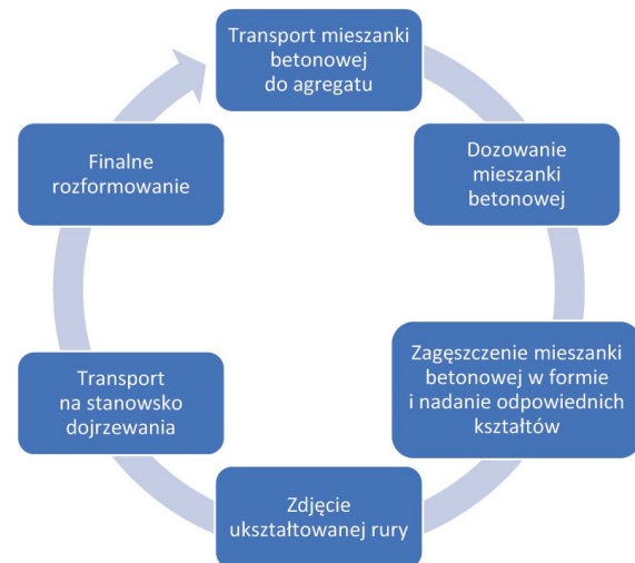
Rys. 14. Ogólny schemat procesu produkcji rur metodą agregatową [14]
