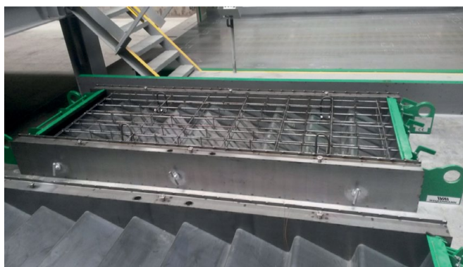
Fot. 10. Forma pojedyncza firmy Weckenmann do produkcji biegów schodowych w pozycji poziomej [17]
