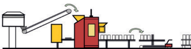
Fot. 7. Schemat działania agregatu do produkcji bloków firmy CGM typu 90H [15]
