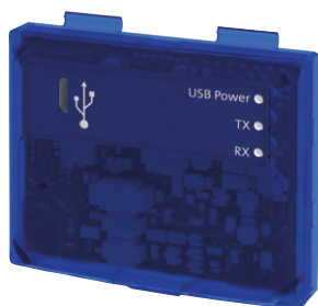
Rys. 5. Do połączenia przemiennika z komputerem wystarczy moduł oraz zwykły przewód USB
