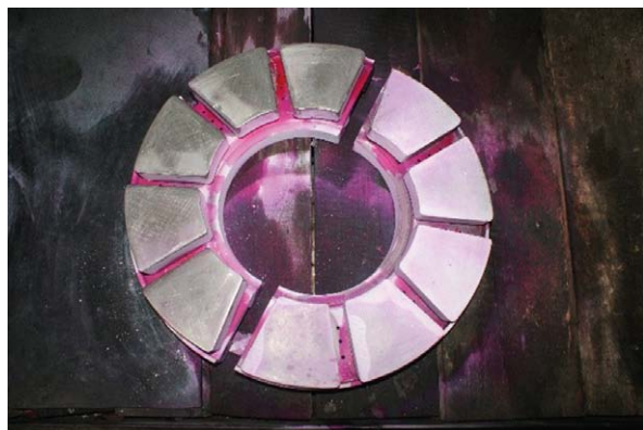
Rys. 6. Łożysko oporowe pokryte penetranem barwnym
