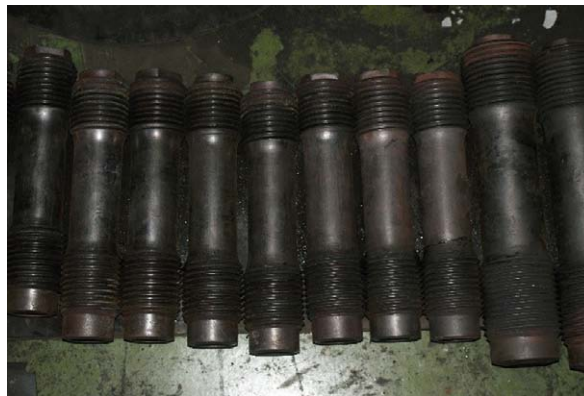
Rys. 8. Śruby dwustronne (szpilki) pokryte penetranem fluorescencyjnym
