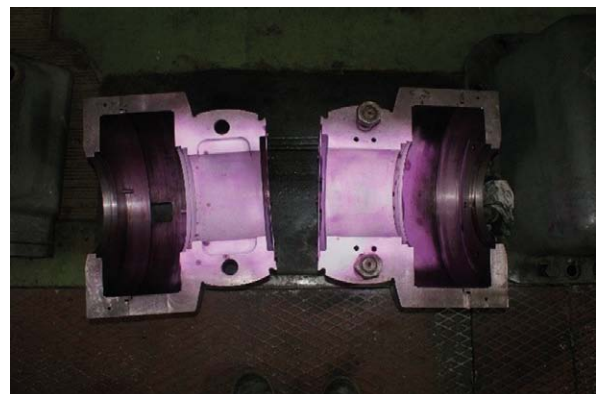
Rys. 5. Panewki turbiny pokryte penetrantem barwnym
