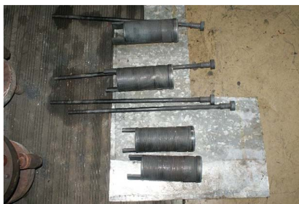
Rys. 7. Zawory grzybków regulacyjnych pokryte penetranem fluorescencyjnym
