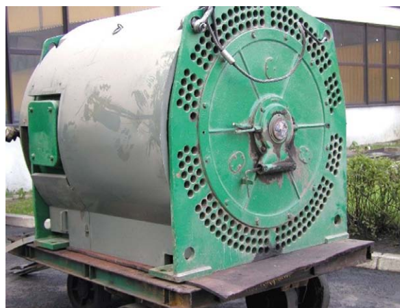
Rys. 1. Silnik indukcyjny dużej mocy z urwanym wałem od strony napędowej
