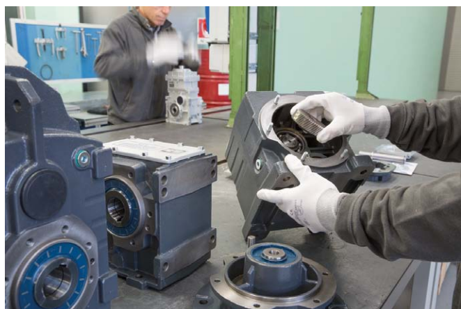
Fot. 4. Montaż przekładni IRON
