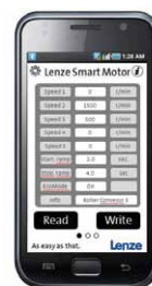
Rys. 3. Bezdotykowe programowanie silnika Lenze Smart Motor odbywa się przy pomocy smartfona z wykorzystaniem technologii NFC
