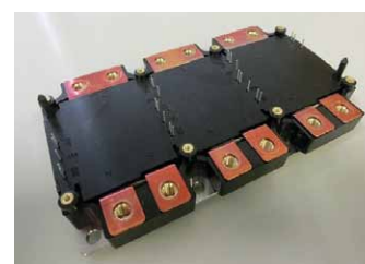
Rys. 7. Moduł testowy 400 A / 1200 V 6-w-1
