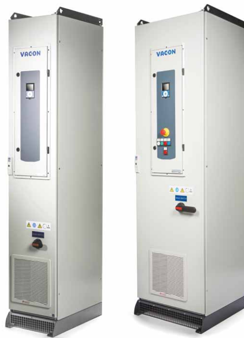
Rys. 1. Przetwornice serii VACON 100 – szafy szerokości 400 mm – do 110 kW, 600 mm – do 315 kW, 1200 mm – do 630 kW (dla 400 V). Widoczna osobno otwierana sekcja sterowania wraz z elementami sterowania lokalnego
