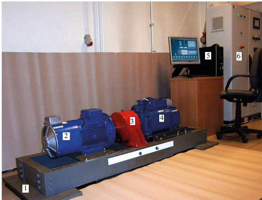
Rys. 2. Widok stanowiska do badania podzespołów hydrokinetycznych: 1 - rama; 2 - sterowany silnik elektryczny; 3 - badany podzespół hydrokinetyczny; 4 - sterowany silnik elektryczny spełniający rolę hamulca; 5 - komputer gromadzący dane pomiarowe; 6 - szafa sterownicza
