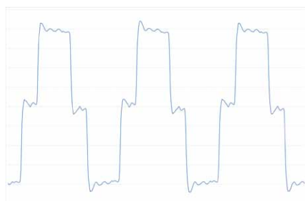
Wynik z pomiaru prądu jednej fazy w przykładowej, mocno zniekształconej sieci elektrycznej
