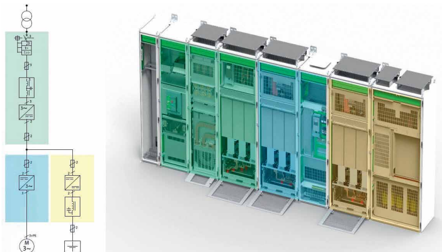
Rys. 3. Konfiguracja hybrydowego układu zasilania napędu AC ze wspólną szyną DC oraz modułami falownika DC/AC i konwertera DC/DC do baterii akumulatorów
