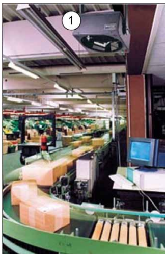
Rys. 18. Wykorzystanie czytnika kodu paskowego na linii produkcyjnej: 1 – czytnik kodu paskowego (Źródło: Cosimir)
