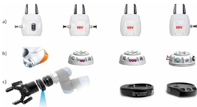
Rys. 27. Przykłady konstrukcji końcówki robotów kolaboracyjnych firmy: a) ABB; b) KUKA; c) ROBOTIQ – dedykowane do robotów firmy Universal Robots
