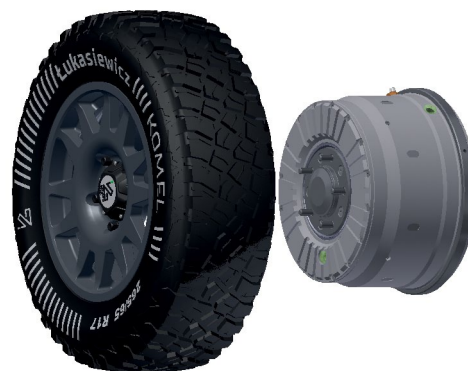
Rys. 2. Konceptcja zabudowy zintegrowanego napędu do użytkowych pojazdów elektrycznych
