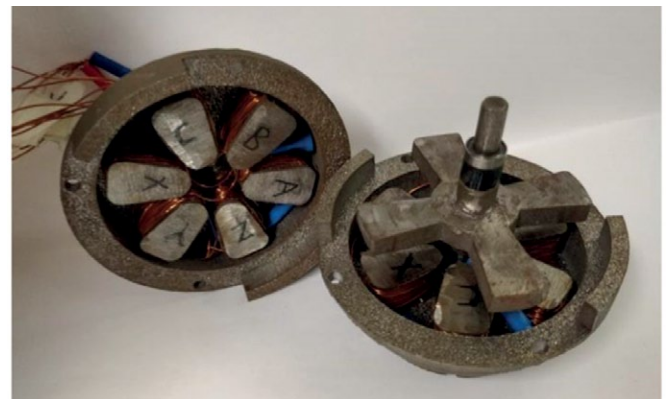
Rys. 4. Silnik reluktancyjny wydrukowany w technologii SLM [9]
