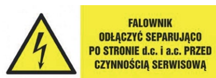
Rys. 8. Oznakowanie ostrzegawcze związane z wykonywaniem czynności serwisowo-konserwacyjnych
