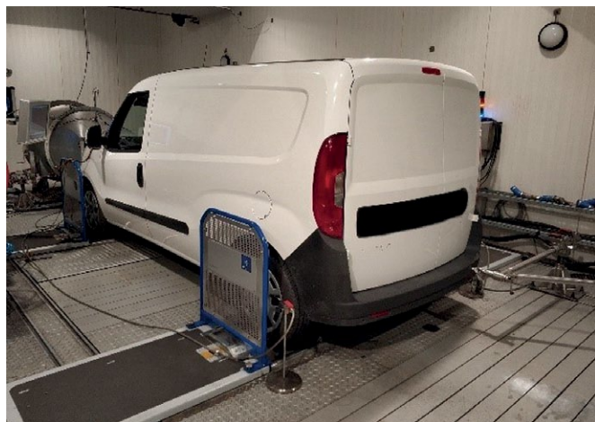
Rys. 2. Pojazd badawczy w trakcie testu na hamowni podwoziowej
