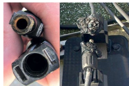
Rys. 2. Wynik niefortunnego parowania złączy różnych producentów
