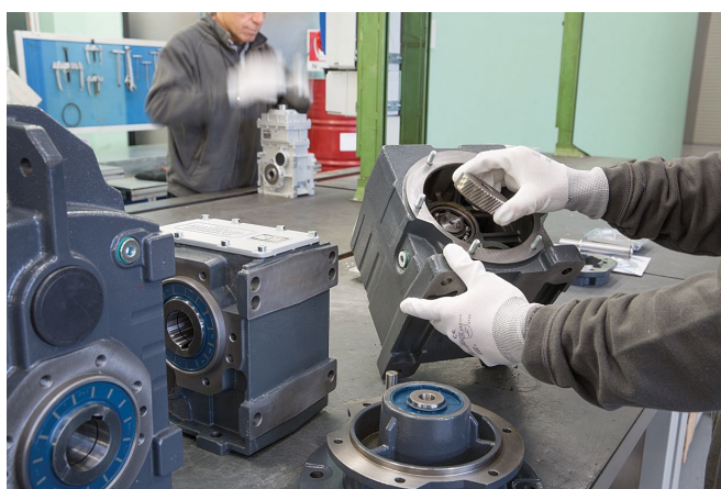
Fot. 4. Montaż przekładni IRON
