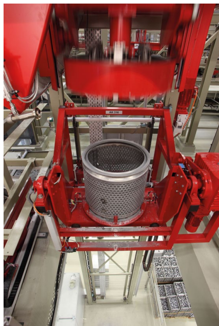
Mniejsze części z wewnętrznymi gwintami są obrabiane w bębnach
