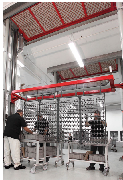
Większe elementy połączeń o wadze do 2,5 kg oraz z delikatnymi gwintami zewnętrznymi pracownicy umieszczają ręcznie na stojakach, co zapobiega uszkodzeniom gwintu podczas powlekania
