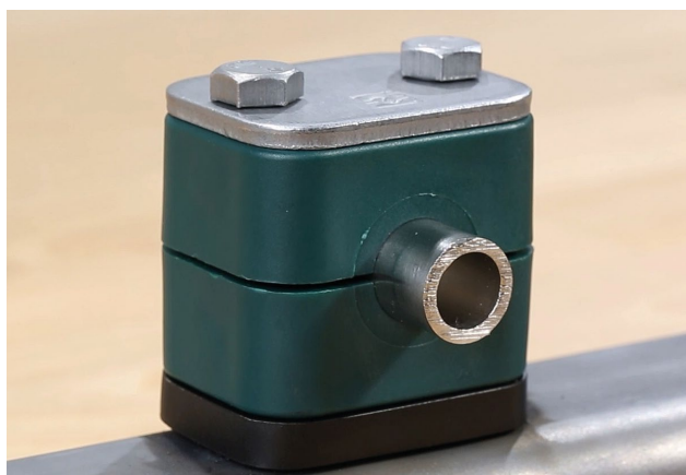
Płytki dystansowa wykonana z tworzywa sztucznego zapewnia odpowiednią odległość uchwytu od konstrukcji
