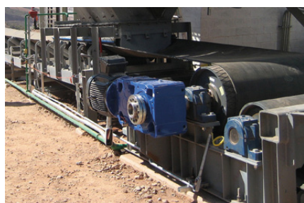
Rys. 1. Typowy przenośnik taśmowy napędzany motoreduktorem stożkowo-walcowym Rossi
