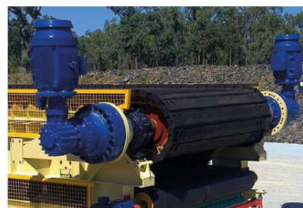
Rys. 2. Napędy planetarne Rossi w przenośniku płytowym
