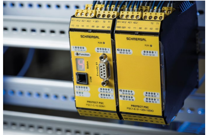
Fot. 3. Nowy modułowy sterownik bezpieczeństwa PSC1 firmy Schmersal umożliwia programowanie indywidualnych systemów bezpieczeństwa
