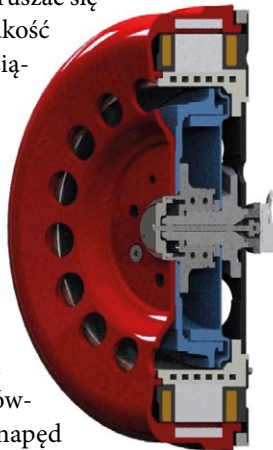
Rys. 3. Model 3D przekroju silnika do zabudowy w piastce koła samochodu elektrycznego
