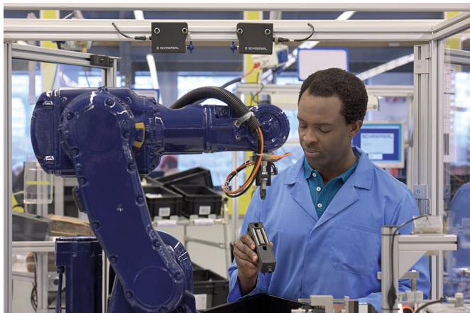
Fot. 5. Bezpośrednia interakcja człowieka z robotem bez separujących osłon bezpieczeństwa będzie zyskiwać na popularności wraz z koncepcją Przemysł 4.0 i będzie wymagać rozbudowanych sterowników bezpieczeństwa
