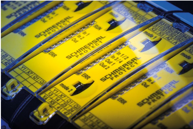
Fot. 2. Wielofunkcyjne moduły bezpieczeństwa serii SRB-E są ekonomicznym rozwiązaniem dla mniejszych maszyn
