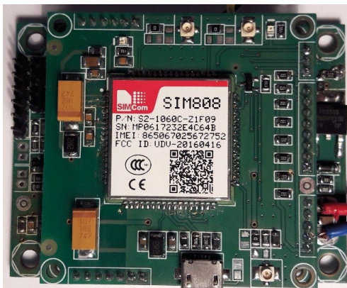
Fot. 1. Moduł komunikacyjny sterownika rowerowego napędu elektrycznego
