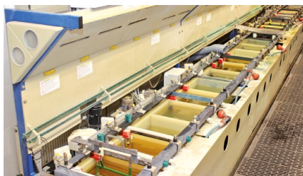
Rys. 1. Galwanizernia w firmie Electrovac służy do nanoszenia cienkich powłok metalicznych na uszczelniane obudowy produkowane w małych seriach
