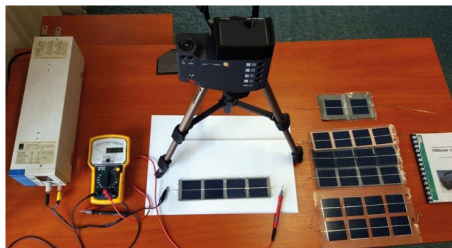
Rys. 11. Stanowisko do badań ogniów słonecznych z wykorzystaniem kamery termowizyjnej
