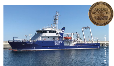
Str. 56 Pierwszy w świecie polski elektryczny napęd statku morskiego o łącznej mocy 1,4 MW
