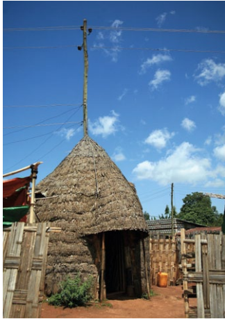
Słup elektryczny jako konstrukcja nośna budynku mieszkalnego
