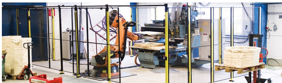
Rys. 1. Przykładowe ogrodzenie ochronne linii technologicznej
