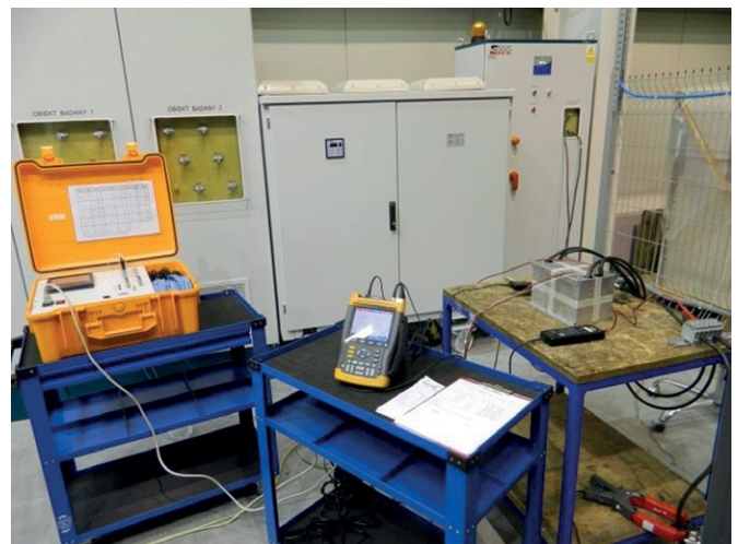
Rys. 6. Zdjęcie stanowiska pomiarowego z badanym transformatorem 30 kVA, 10 kHz
