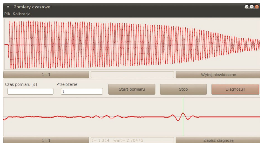
Rys. 2. Okno programu z zaimplementowaną procedurą diagnostyczną – wynik dla silnika uszkodzonego
