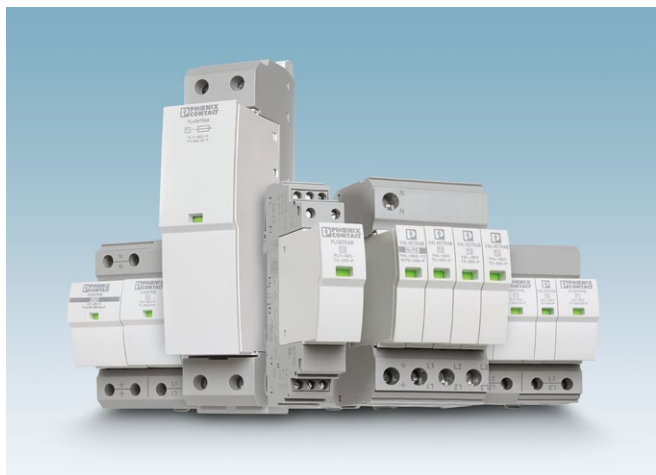
Rys. 2. Nowy wachlarz uniwersalnych urządzeń ochrony przed wyładowaniami atmosferycznymi i przepięciami z zastosowaniem technologii Safe Energy Control – nowy iskiernik zapobiega powstawaniu prądów następczych i umożliwia rezygnację z dodatkowego bezpiecznika
