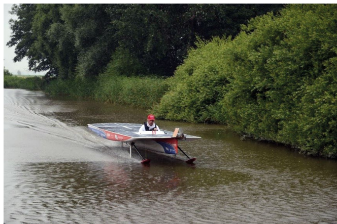
Rys. 1. Najszybsza łódź solarna podczas regat Dutch Solar Challenge 2016 – wodolot „Clafis” płynie na płatach mimo deszczowej pogody dzięki energii zgromadzonej w akumulatorze
