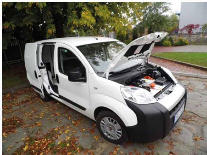
Rys. 1. Fiat Fiorino z silnikiem PM wyprodukowanym przez KOMEL, projekt nr NR01-0084-10
