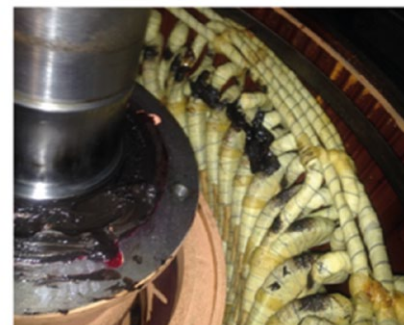
Rys. 6. Uszkodzone łożysko silnika oraz zanieczyszczone uzwojenia stojana
