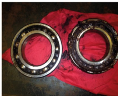
Rys. 6. Uszkodzone łożysko silnika oraz zanieczyszczone uzwojenia stojana
