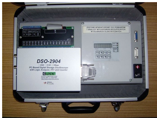
Rys. 16. Przenośny zestaw aparaturowy do pomiarów wnz silników [24, 25]
