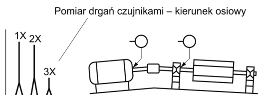
Rys. 10. Niewspółosiowość kątowa („rozwarcie na sprzęgle”): po lewej u góry – charakter widma w kierunku osiowym (wyniki pomiarów drganiowych w uproszczeniu); u dołu – relacje fazowe na łożyskach [178, 273]
