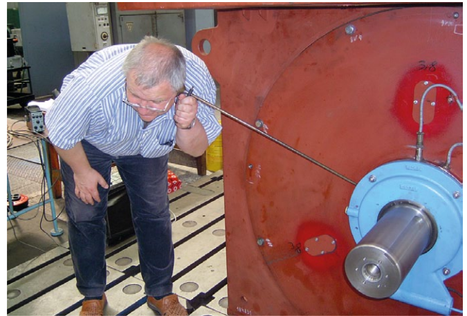
Rys. 23. Najprostszy sposób diagnozowania łożyska tocznego (osłuchiwanie łożyska przez jednego z autorów) [266]
