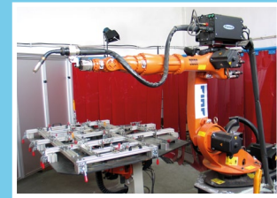
Zrobotyzowane stanowisko spawalnicze METAL FACH Sokółka
