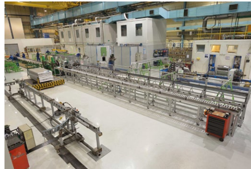
Rys. 2. Widok ogólny automatycznej linii Mazanego do formowania tzw. „zielonych” prętów generatorów
