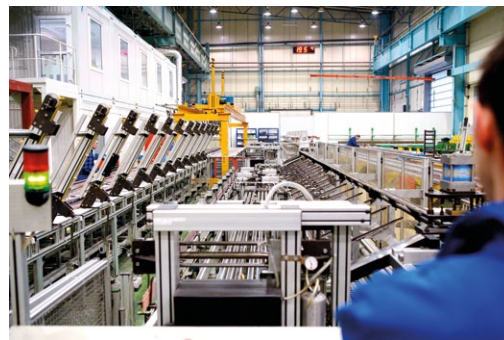
Rys. 3. Automatyczna linia Mazanego do formowania tzw. „zielonych” prętów generatorów
