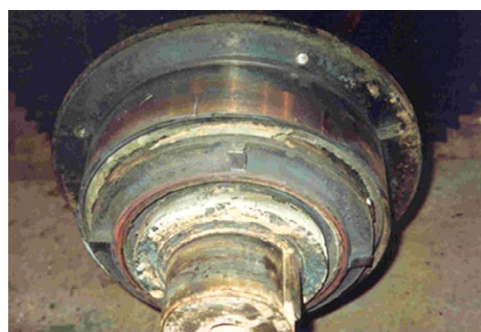
Rys. 8. Uszkodzone łożysko wałeczkowe
