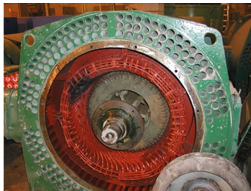
Rys. 1. Silnik indukcyjny dużej mocy z urwanym wałem od strony napędowej oraz zwarcie zwojowym w obrębie połączeń czołowych
