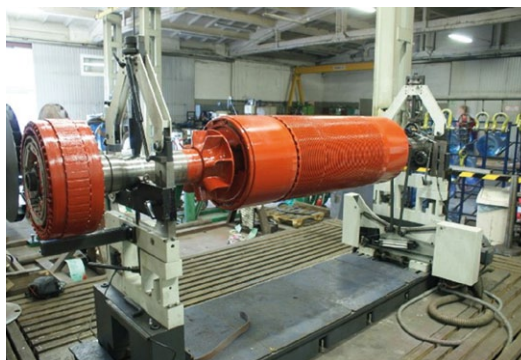
Rys. 21. Wyważanie wirnika silnika synchronicznego wraz ze wzbudnicą bezszczotkową
