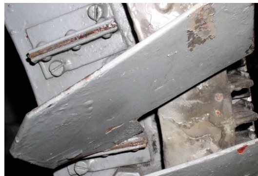
Rys. 7. Zerwanie łopatki wentylatora przy mocowaniu do korpusu wirnika [1, 2]
