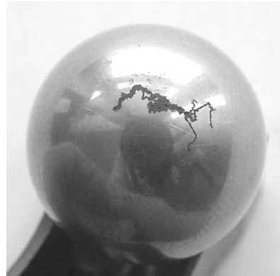
Rys. 14. Widoczne zygzakowate przypalenia na powierzchni kulki
