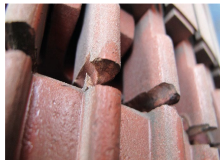
Rys. 4. Przełom uszkodzonych prętów wirnika silnika trakcyjnego
