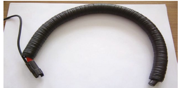
Rys. 19. Przykład elastycznej cewki Rogowskiego własnej konstrukcji przeznaczonej do pomiarów prądu w silnikach WN
