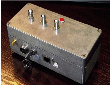
Rys. 1. Autonomiczny system akwizycji danych w wykonaniu trójkanałowym
