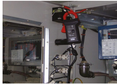
Rys. 13. Prądowy hallotronowy czujnik cęgowy obejmujący przewód amperomierza
