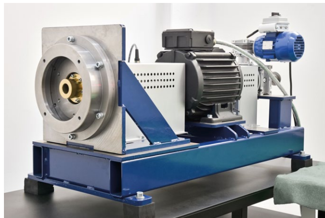
Rys. 3. Stanowisko montażowe hamowni 15 kW
