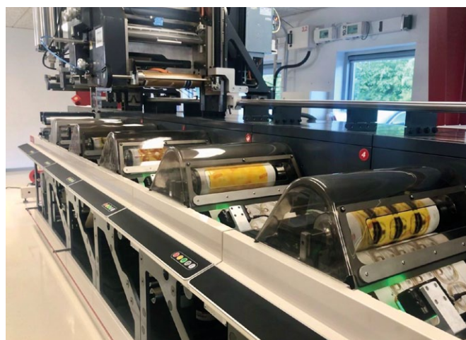
Firma Nilpeter wyposaża każdą z sześciu drukarek etykiet w kamerę systemu wizyjnego B&R
