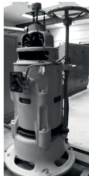
Rys. 37. Przetwornica elektromaszynowa wyprodukowana w fabryce w Żychlinie w okresie międzywojennym (zdjęcie autora)
