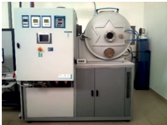
Rys. 1. Urządzenie do nanoszenia powłok metalicznych na materiały włókiennicze metodą rozpylania magnetronowego
