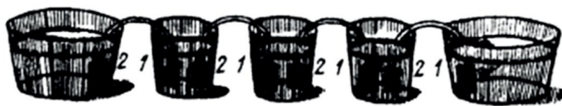
Rys. 8. Naczyniowa bateria Volty [41]
