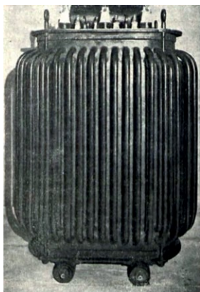
Fot. 3. Transformator olejowy 400 kVA „Elektrobudowy”, czynny na Powszechnej Wystawie Krajowej w Poznaniu w 1929 r.
