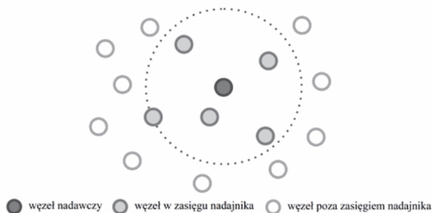
Rys. 2.1. Ograniczony zasięg transmisji w sieciach ad hoc
