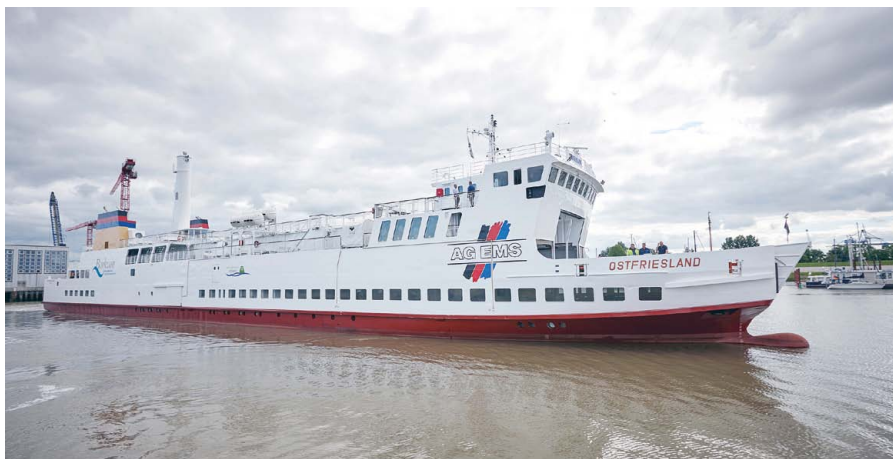
Prom Ostfriesland łączy miasto Emden z wyspą Borkum od mniej więcej 30 lat. W lecie 2015 roku zmieniono jego napęd z parowego na napęd zasilany gazem skroplonym
