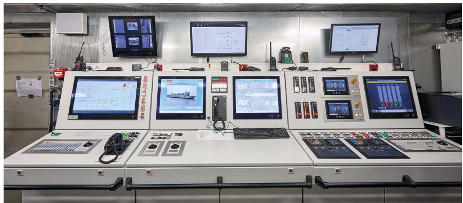
Aby zapewnić członkom załogi wgląd we wszystkie funkcje promu, w centrali kontrolno-manewrowej wielkie ekrany dotykowe zostały zintegrowane z systemem TP firmy Rittal
