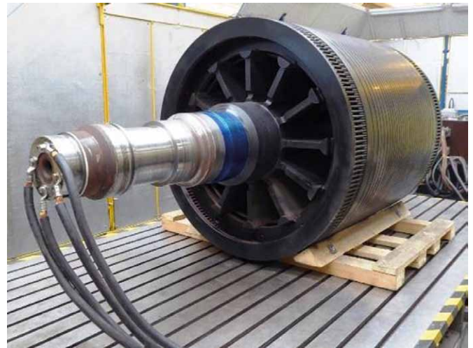
Rys. 29. Widok badanego wirnika z przewodami układu wymuszenia prądu w wału
