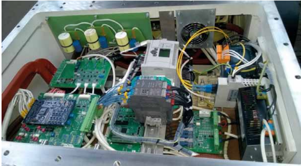
Fot. 3. Przebiegnik częstotliwości silnika 500 kW, 1140 V. Główny sterownik w wersji ze sterownikiem PLC
