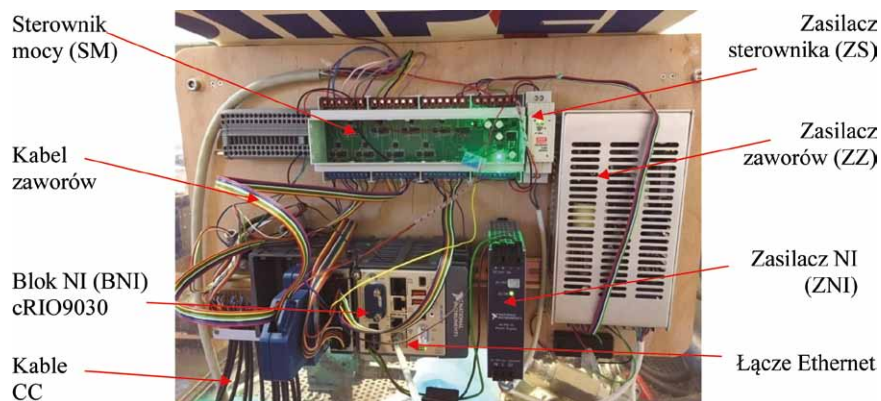
Rys. 4. Stanowisko badawcze – moduł sterująco-pośredniczący
