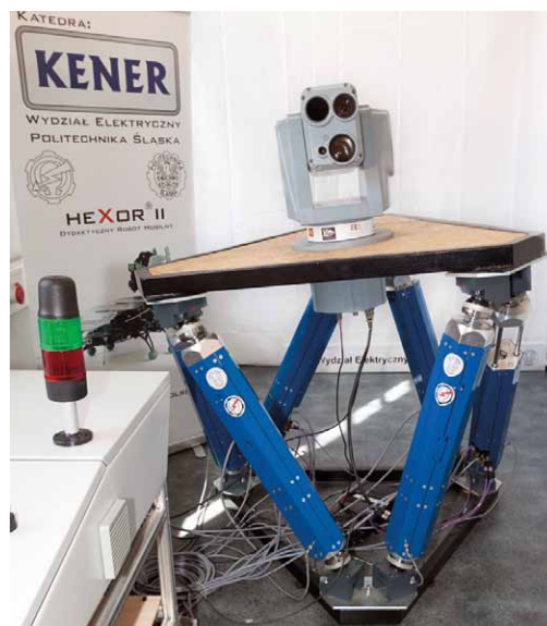
Rys. 6. Moduł MSZP na stanowisku symulującym warunki pracy na morzu
