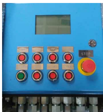
Fot. 2. Sterownik mikroprocesorowy produkcji DFME DAMEL SA – pulpit sterujący PS-2008/1 do sterowania silnikami
